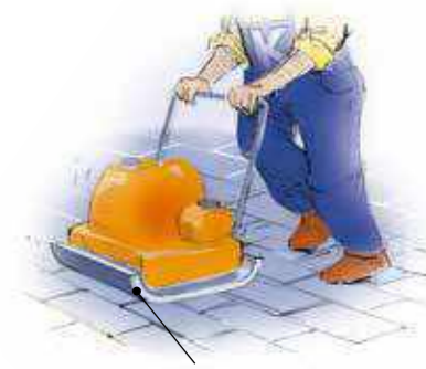
okładzina PCV chroniąca kostkę przed uszkodzeniami
